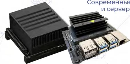
Мобильные вычислительные платформы с графическими и тензорными процессорами
