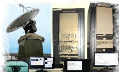
Комплекс приёма и обработки информации с космического аппарата
